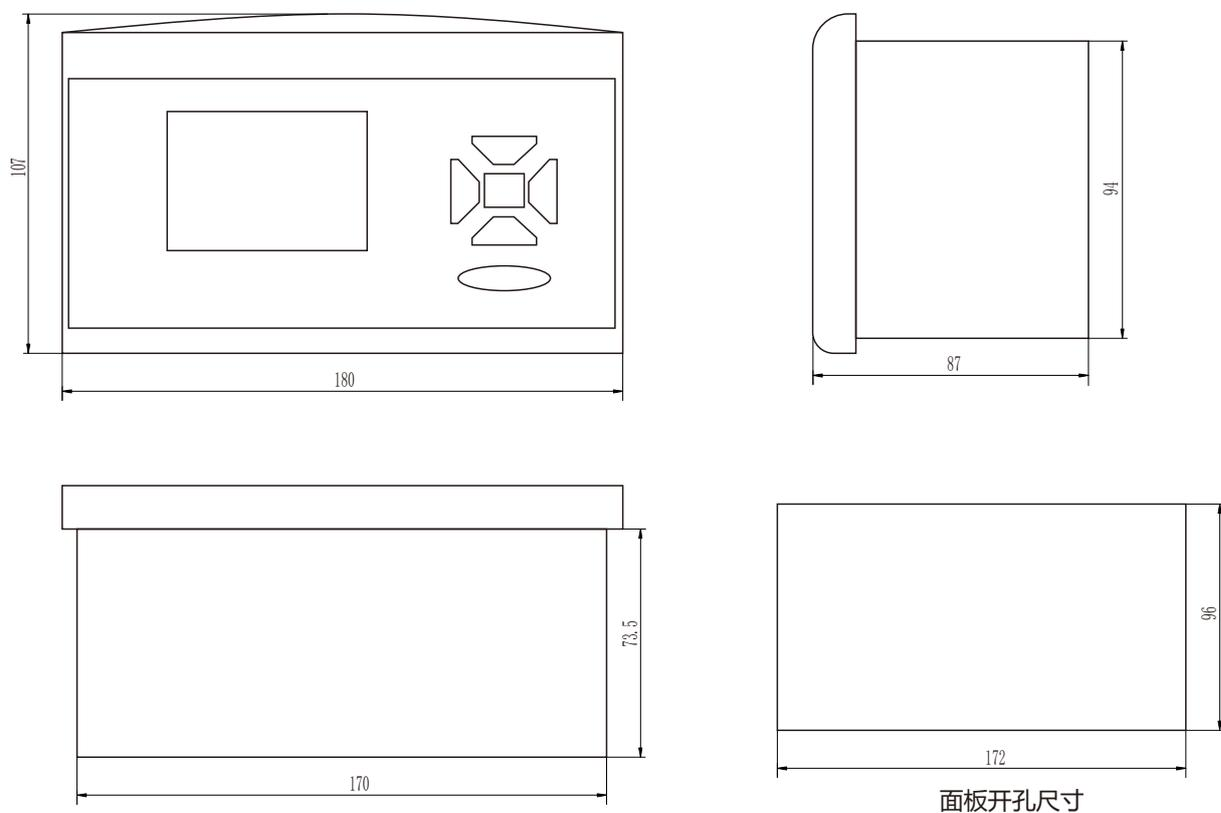
注:安装时,将双电源控制器放入面板开孔内,并用四个卡子将控制器卡紧在面板上;
